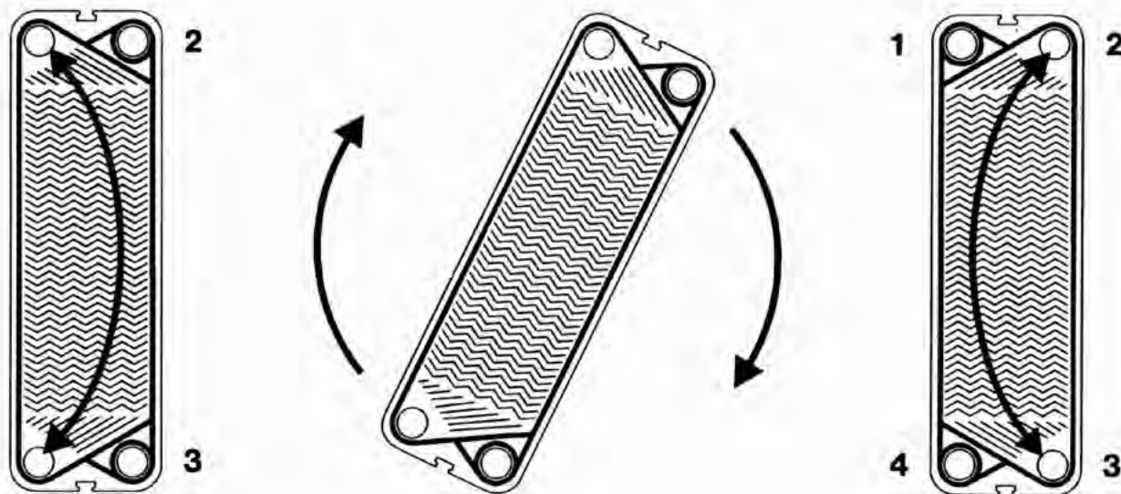
Рисунок В.4 – Схема преобразования левой пластины L в правую пластину R для их компоновки и правильной сборки
