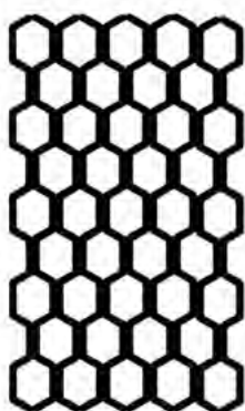
Рисунок В.5 – Вид пакета пластин при правильной сборке
