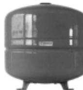
**STARVAREM LR** Емкость цилиндрической, с округлыми краями формы. Мембрана - диафрагменная, SBR-типа, разделяет бак на две части: в верхней находится предварительно закаченный воздух, в нижнюю поступает расширяющаяся вода. Баки этого типа имеют опоры, присоединительный патрубок располагается сбоку. Применяются в системах отопления, кондиционирования, холодильных установках.
